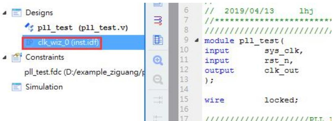
7. 我们再来编写一个顶层设计文件来实例化这个 PLL IP, 编写 pll\_test.v 代码如下。
