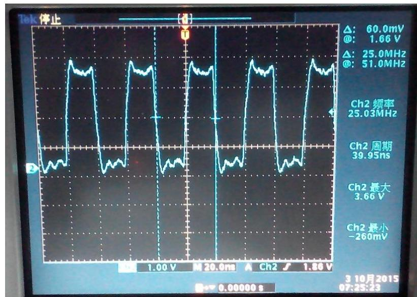
如果您想输出其它频率的波形，可以修改时钟的输出为 `clk_wiz_0` 的 `clkout0` 或 `clkout1` 或 `clkout2`。也可以修改 `clk_wiz_0` 的 `clkout3` 为您想要的频率，这里也需要注意一下，因为时钟的输出是通过 PLL 对输入时钟信号的倍频和分频系数来得到的，所以并不是所有的时钟频率都可以用 PLL 能够精确产生的，不过 PLL 也会自动为您计算实际输出接近的时钟频率。
