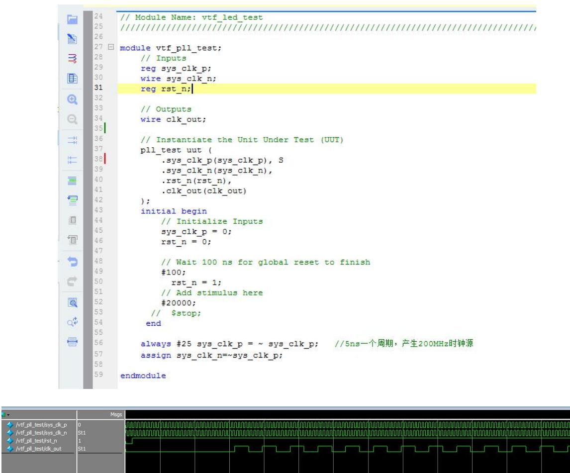
波形图中 sys\_clk\_p 为 200MHz 的系统时钟，rst\_n 为复位信号，clk\_out 为 PLL 输出的 25MHz。
