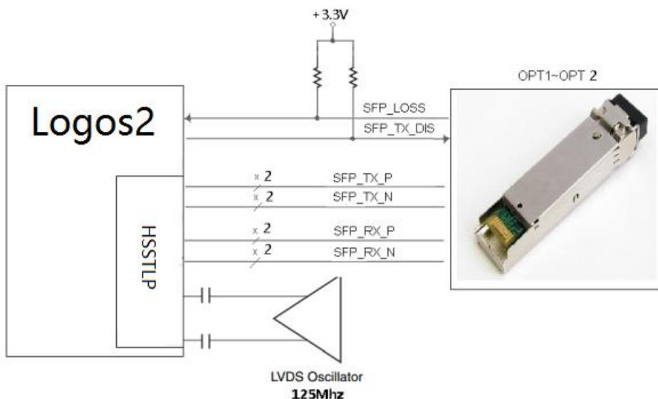
其中 SFP1 光模块接口连接到 Q3 HSSTLP 的 Channel3 上，SFP2 跟 Q3 HSSTLP 的的 Channel2 相连。光模块和 FPGA 之间用 0.1uf 的电容隔开，使用 AC Couple 的模式。
